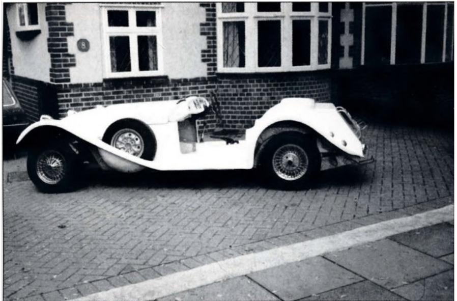
*Oben: Die Montage der Karosserie war einfacher als erwartet und es wurden verschiedene Unterlegscheiben verwendet, um ein Klappern der Karosserie gegen das Fahrgestell zu vermeiden. Unten: Das separate Cockpit-Oberteil fungiert auch als Armaturenbrett-Hintergrundplatte, in die Roy einige Triumph-Dolomite-Instrumente einpasste.*
